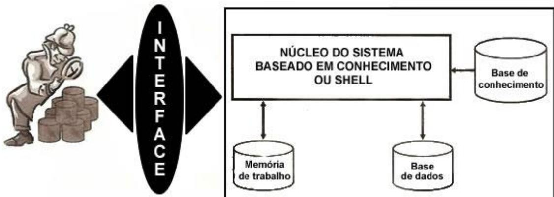
**Figura 2.1 Estrutura de um Sistema Baseado em Conhecimento**
