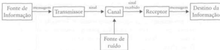
FIGURA 1 - Diagrama esquemático de um sistema de comunicação.
